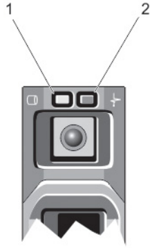
図 2. 前面 HDD または SSD インジケータ
